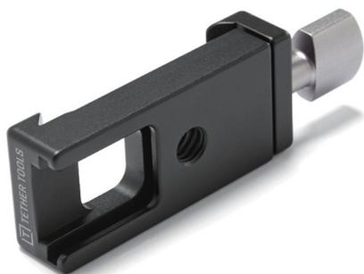
エアーダイレクトアルカクランプフォーL-ブラケットを使用することで、エアーダイレクト本体をカメラの側面に簡単に取り付けすることができます。コールドシューで本体をアルカクランプに固定します。アルカスタイルのL-ブラケット（※）に直接固定できるクイックリリースが付属しています。コールドシューには、エアーダイレクト本体だけではなく、フラッシュなどのアクセサリを取り付けられます。また、アームやLEDライトなどを固定するための1/4-20インチのネジ穴も空いています。
