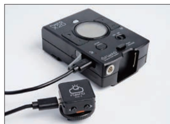
ニッケル水素電池使用時には、トランスミッターと同時充電が可能
