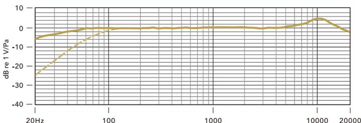
マイクロフォンの振動板にどれくらいの音域が集音できるかという範囲をヘルツ (Hz)、音の大きさをデシベル (dB) と表します。最も感度が高い1,000Hzの値を基準(0dB)としてグラフに示し、ここから読み取る特徴を周波数特性と呼びます。全体の集音範囲で一定の感度を持つ特性をフラットと呼び、集音した音は原音に忠実となります。ある範囲の感度に变化があるものは、特定の用途に適しているということになります。コンデンサーマイクは、一般的なものでも50Hzから15,000Hzくらいまでの幅広くフラットな特性を持っています。ダイナミックマイクでは80Hzから12,000Hz程度に留まりますが、特別な用途を除けば、どんなマイクロフォンでも人間の耳には十分に広い周波数帯域を持っていると言えます。
