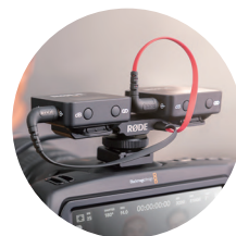
SC11とDCS-1を使用すれば 一眼レフに2台のマイクを接続可能
