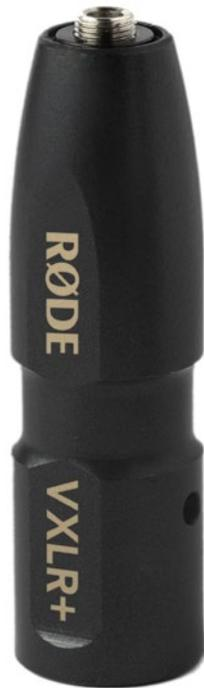
VXLR+ は、XLR 端子から供給される 12-48V のファンタム電源を、3-5V のプラグインパワーに変換できる、XLR-TRS 変換アダプターです。RØDE VideoMic GO や VideoMicro をはじめとするプラグインパワー対応マイクを、XLR 接続で使用できます。3.5mm TRS 端子にはロックナット用のネジが切っており、HS2 や Filmmaker kit レシーバーなどのロック付きケーブルについているロックナットと組み合わせて使うことで、抜け落ちを防止し確実に接続できます。
