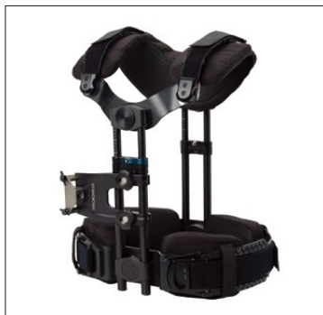
クリスフォーセットによって開発された、エクソベスト。肩と腰だけで支え、その2点をピボット構造のブリッジによって結んでいます。肩や腰、股関節の動きの自由度が飛躍的に向上し、より自然な歩き方で撮影を行えるようになり疲労を軽減できます。
