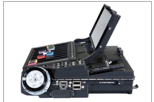
本体右側面：SDカードスロット、USB、イーサネットコネクタとメインダイヤル
