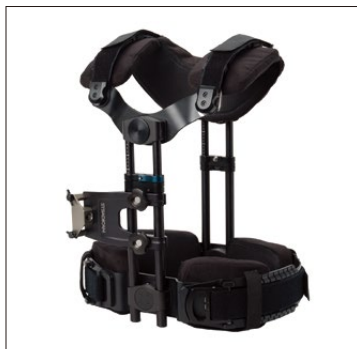
クリスフォーセットによって開発された、エクソベスト。肩と腰だけで支え、その2点をピボット構造のブリッジによって結んでいます。肩や腰、股関節の動きの自由度が飛躍的に向上し、より自然な歩き方で撮影を行えるようになり疲労を軽減できます。
