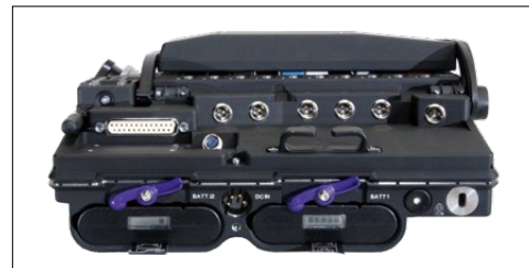
本体背面：バッテリー、電源入力、アナログ入出力端子など ※バッテリーは付属しません
