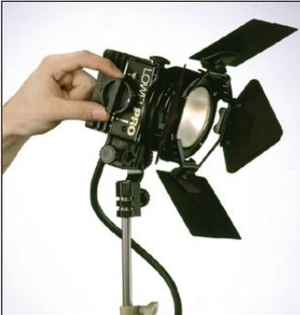
プロライトは小型・軽量でありながら、配光効率に優れ、入力がACの場合最大250w、DCの場合12v100w、または30v200wの使用が可能。AC/DCの切り替えはランプ交換とヘッドケーブルの交換だけで終わります。(DCケーブルはオプション) 室内での使用はもちろん、ロケーションライトとしても最適です。小型ながら照射角度は18°~33°のビームコントロールが可能。スーパースポット用レフに交換すれば照射角度10°の強力なスポットライトにもなります。
