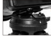
溝にプレートを差し込み下へ押し込む
