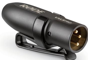
VXLRプロは、3.5mm TRSコネクタをXLRコネクタへ変換し、さらにアンバランス信号をバランス信号に変換、ファンタム電源をプラグインパワーに変換するアダプターです。ロードマイクロフォンス製のビデオマイクNTGやワイヤレスゴーを、XLR入力のカメラやレコーダーに接続可能にします。マイクの脱落を防ぐために、3.5mm TRS側にはロック機能が付いています。アンバランス信号をバランス信号に変換する内部設計を搭載しており、ケーブル延長時の安定性の向上やノイズの軽減を図ります。ハンドグリップ型ショックマウントPG2-R（別売）にぴったり嵌まる形状で、シンプルなセットアップを叶えます。また、VXLR+と同様に12-48Vのファンタム電源を3-5Vのプラグインパワーに変換し、ビデオマイクロやビデオマイクゴーといったプラグインパワーで駆動するマイクを使用可能にします。
