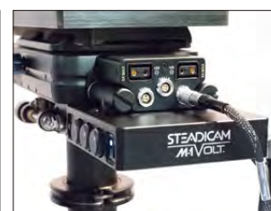
本体ステージから電源供給します
