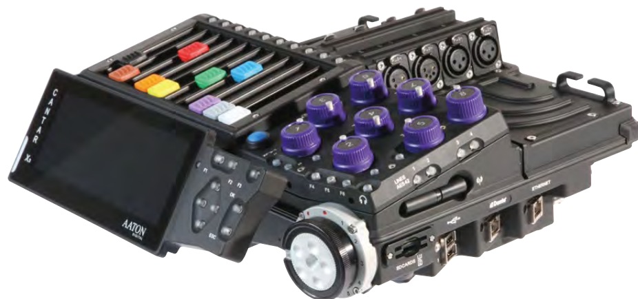
本体右側面：SDカードスロット、USB、イーサネットコネクタなど
