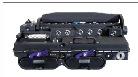
本体背面：バッテリー、電源入力、アナログ入出力端子など ※バッテリーは付属しません
