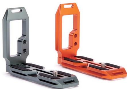
QR11 2.0は、ミラーレスカメラや一眼レフなど、さまざまなカメラボディに対応した汎用性の高いLブラケットです。1/4インチネジ穴が2つ切られているため、アームなどを取り付けられます。また、落下防止用にストラップ取り付け用のスロットが設けてあります。側面のプレートはカメラに合わせて向きを変えられます。
