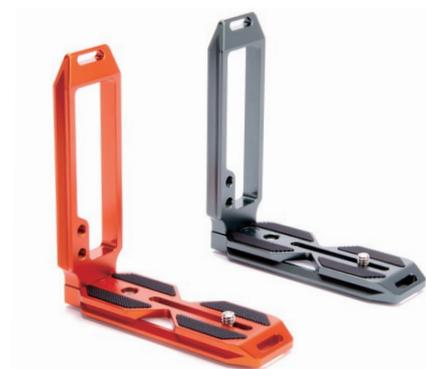
QR11 フルボディ 2.0 は、さまざまなグリップ付きカメラボディに対応した汎用性の高いLブラケットです。1/4インチネジ穴が2つ切られているため、アームなどを取り付けられます。また、落下防止用にストラップ取り付け用のスロットが設けてあります。側面のプレートはカメラに合わせて向きを変えられます。
