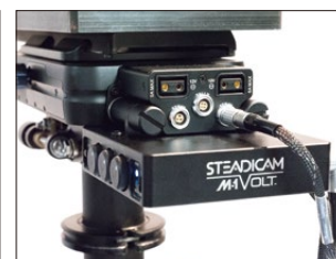
本体ステージから電源供給します。
